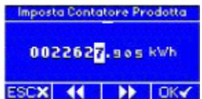
Sul Display Remoto seguire: **Menu / Gestione Parametri / Imposta Contatore Prodotta**
